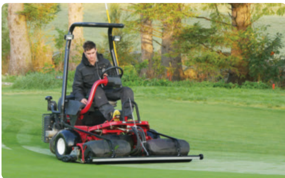
Børstedelen foran på klipperen reiser opp gresset før det kuttes. Alf Inge Bjørnsen med Toro 3250 på 17'en.
